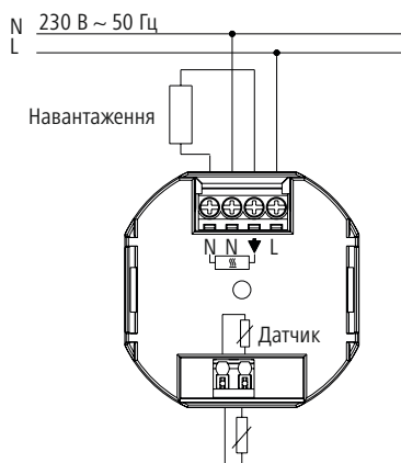
Схема з'єднань вбудованого регулятора «x-net +e», 230 В
