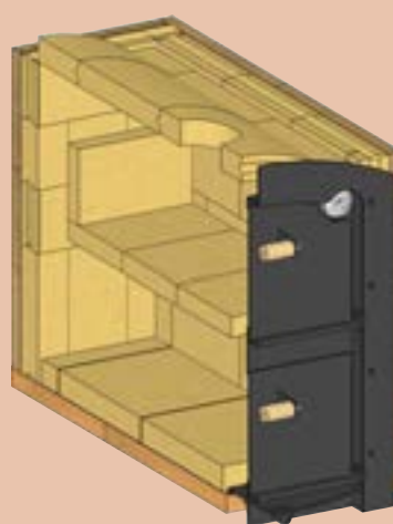
КаВОВ N+F 5072D Разрез двухъярусной печи с двойной дверцей
