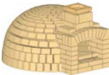
Артикул 5986 включено: Конструкция пода и входного отверстия
